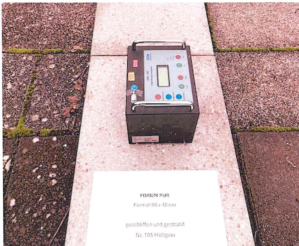
Bild 1. Die zu prüfende Plattenoberfläche FORUM PUR, Hellgrau Nr. 105, geschliffen und gestrahlt.
