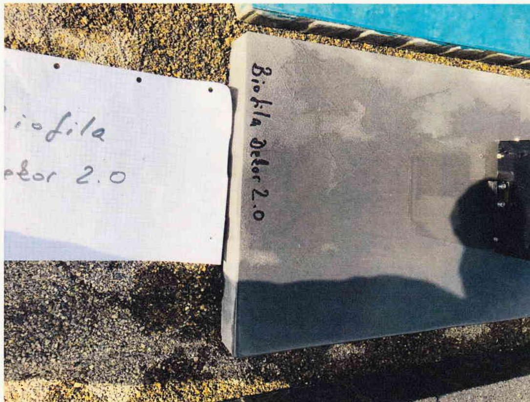
Bild 1. Die zu prüfende Betonoberfläche Terrassenplatte, BIOFILA Dekor 2,0, hydrophobiert, im aufgebauten Zustand.
