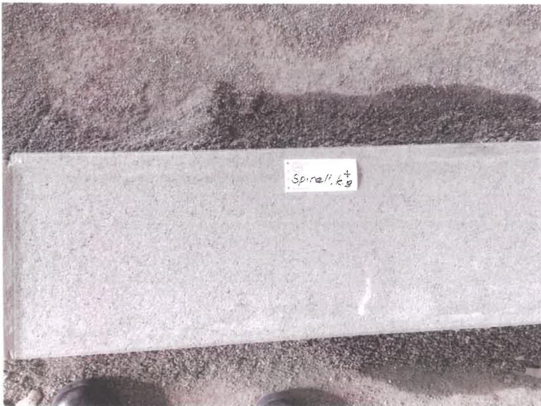
Bild 1. Die zu prüfende Pflasteroberfläche **SPIRELL kugelgestrahlt** im aufgebauten Zustand.
