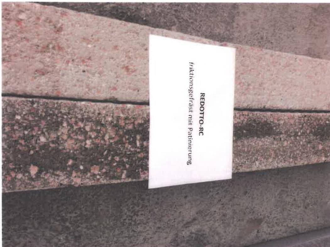
Bild 1. Die zu prüfende Betonoberfläche REDOTTO-RC, friktionsgefräst mit Patinierung.
