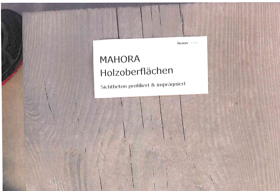
Bild 1. Die zu prüfende Oberfläche, MAHORA DIELENSTEINE, profiliert+ hydrophobiert , im aufgebauten Zustand.
